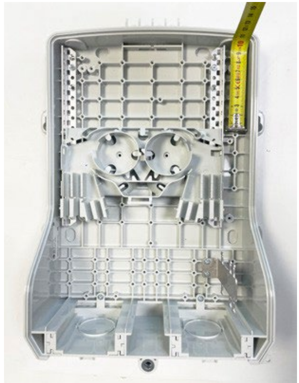
4.1.2 Den FAS-Block nach unten versetzen. Es werden 10cm für die Montage der Spleißkassetten benötigt.
