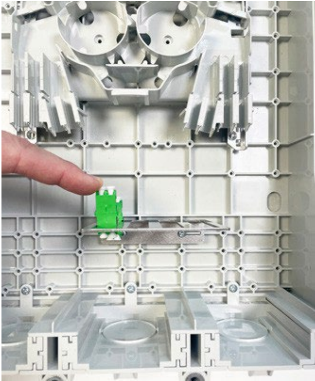
4.2.3.5 Kupplungen installieren. Die Kupplungen werden von oben eingerastet.
