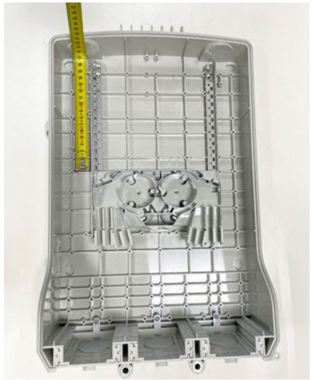
4.2.12 Den FAS-Block nach unten versetzen. Es werden 17cm für die Montage der Spleißkassetten benötigt.
