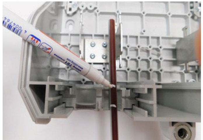
624 Mikrorohr entsprechend der Markierung einkürzen, wieder in die Kabeleinführung einlegen und Abdichtbereich markieren.
