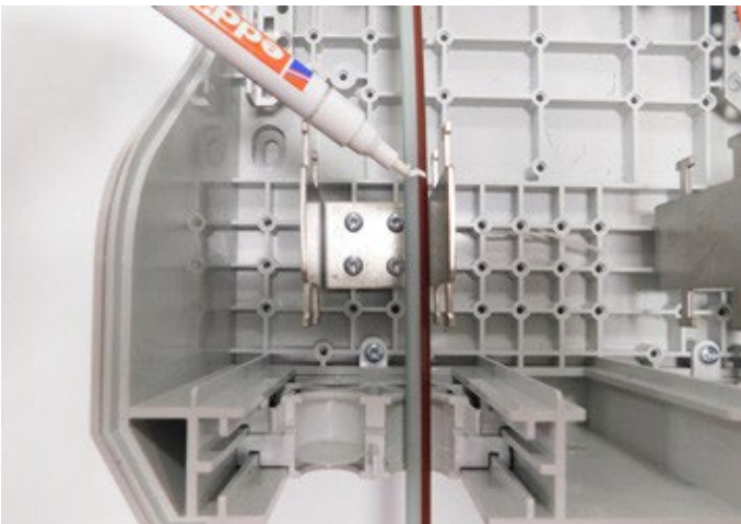
623 Mikrorohr in die Kabeleinführung einlegen und Absetzpunkt markieren.
